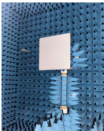
電波暗室でのアンテナ測定例
