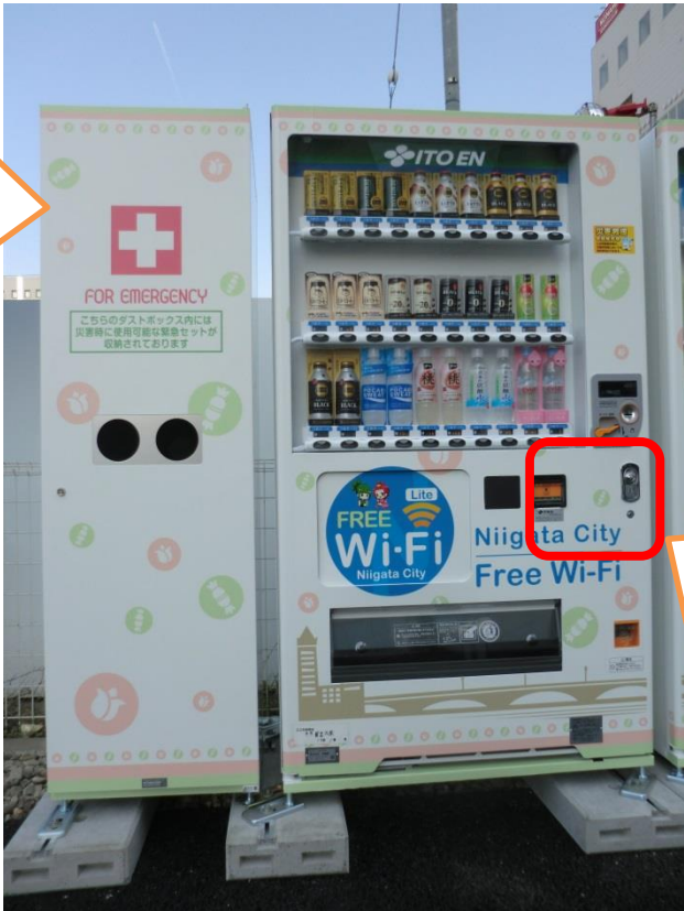
①災害支援自動販売機 (バッテリーの操作による貯蔵飲料提供)
